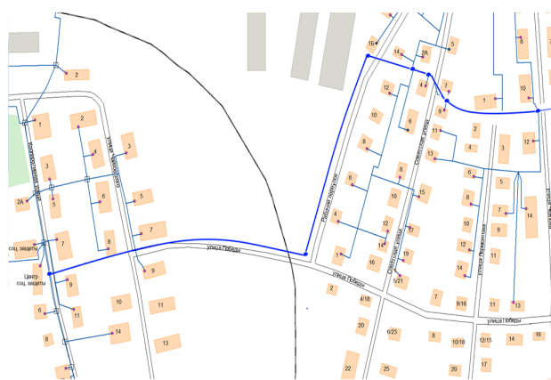
Рисунок 6.4.1 – Схема тепловой сети на п. Поссовет от сетей п.г.т. Ветлужский
